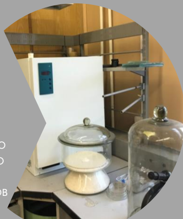
Камера для исследования антимикробных свойств упаковочных материалов
