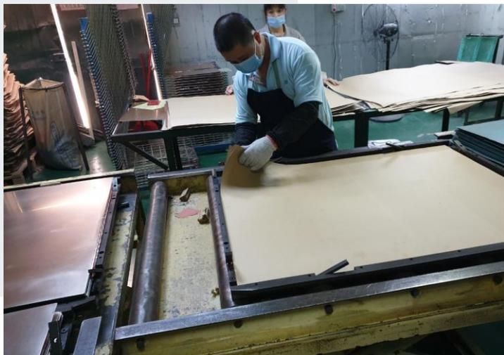
Укладка прокладочного картона в стопы с электронными платами
